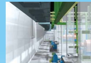
首钢京唐2250mm热轧地下箱型基础三维仿真设计
